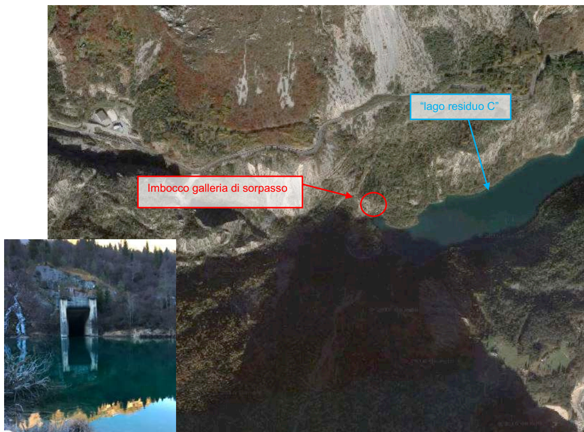
Figura 2: Ortofoto aerea dell'area di imbocco della galleria di sorpasso (esistente) e particolare dell'opera di presa della galleria di by pass
